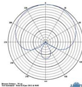
El micrófono de condensador MU-20 es la opción premium de la familia MU, que incluyen el MU-10 (cardioide), MU-16 (semi supercardioide) y que viene incluido en todos los modelos de instrumentos y el MU-20 (Supercardioide).
